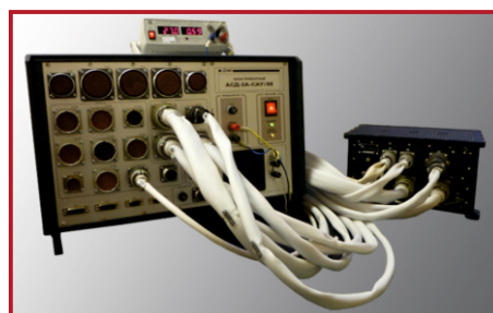
Рабочее место на базе КДК-САУ для проверки БАРК
