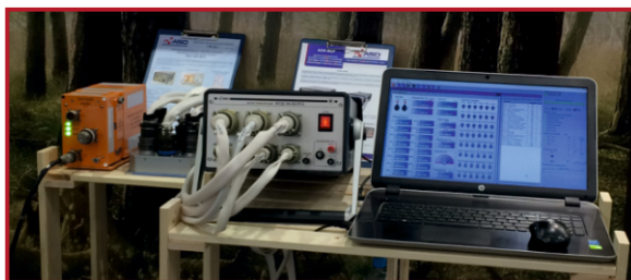
Рабочее место на базе КДК-БСР для проверки системы СДК-8Р
