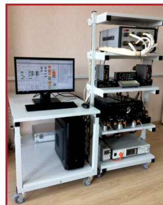
Рабочее место на базе КДК-СТР для проверки системы топливомерно-расходомерной самолетов Су-30
